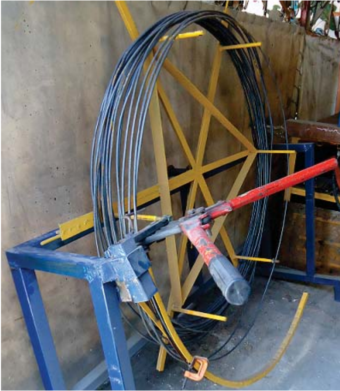
Fig. 2. Montaje del rollo de alambón.
