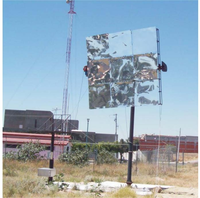
Fig. 2. Helióstatos empleados para la captación de la radiación solar. La energía incidente es direccionada a un espejo concentrador parabólico fuera de eje, el cual dirige la radiación hacia la entrada de una cámara de cocción.
