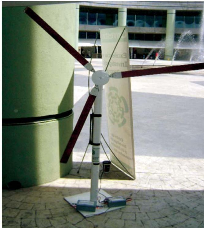
Figura 4. Prototipo didáctico de aerogenerador.
