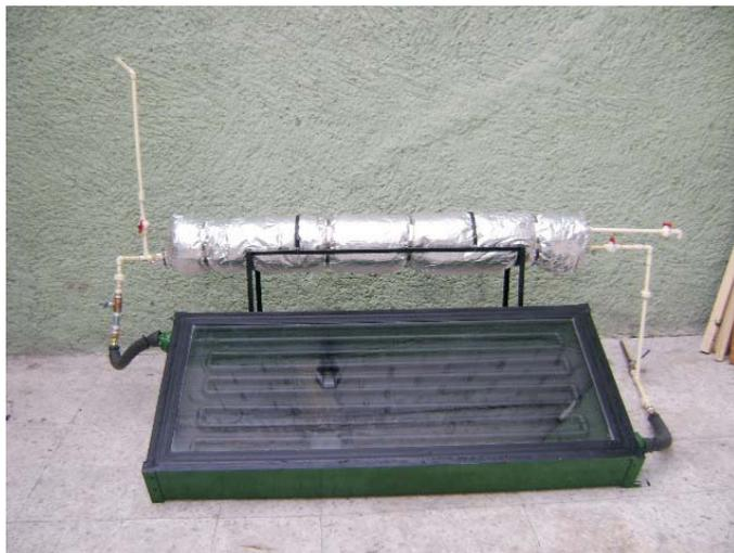
Figura 2. Modelo de calentador solar con capacidad para calentar 30 litros de agua, a una temperatura de 70 °C.
