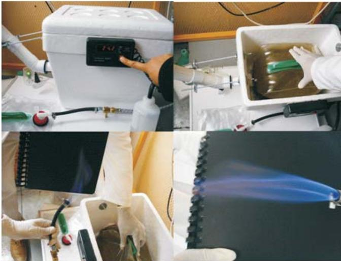
Figura 5. Proceso para obtener biogás.
