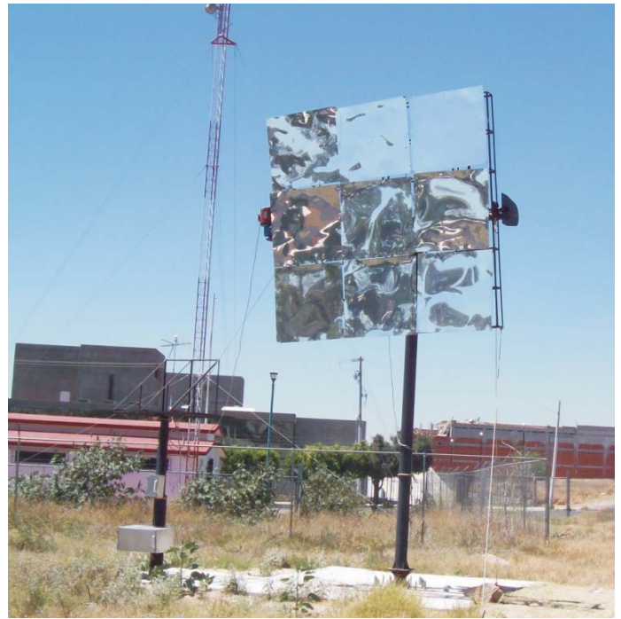
Fig. 2. Helióstato empleado para la captación de la radiación solar. La energía incidente es direccionada a un espejo concentrador parabólico fuera de eje, el cual dirige la radiación hacia la entrada de una cámara de cocción.
