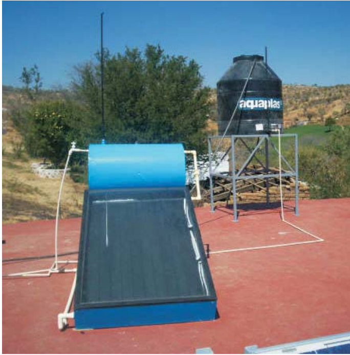
Fig. 1. Prototipo de calentador de agua de placa plana de acero galvanizado. Desarrollo realizado con fines de proveer a las amplias capas de la población residente en el altiplano mexicano de un dispositivo robusto y de bajo costo, aprovechando el excelente recurso solar que se da en esta zona, ante todo en las temporadas de otoño e invierno, cuando más requiere de agua caliente.
