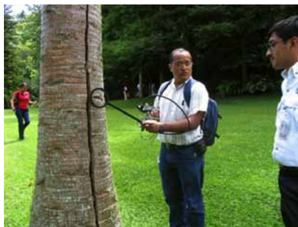
Figura 7. Tomando lectura de microchip con antena.
