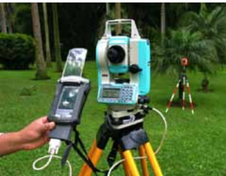
Fig. 3. Tomando lectura con la estación total.
