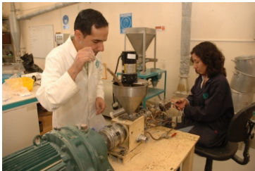
Extrusor de alimentos con capacidad para 50 kg/h.
