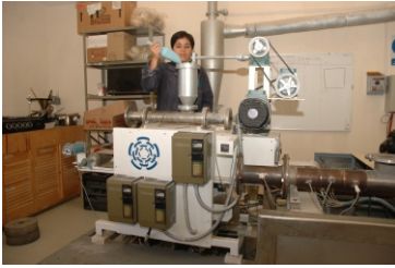
Extrusor de alimentos con capacidad para 5 kg/h.
