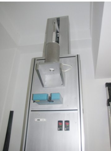
Torre de estirado de fibras ópticas de plástico.
