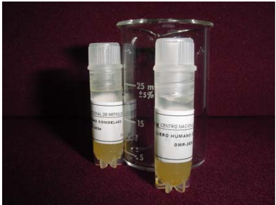
Fig. 1. DMR 263 a . Material de referencia certificado para la medición de glucosa, colesterol, urea, ácido úrico y creatinina en suero humano.
